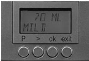
Für die Programmierungen werden die Funktionstasten unter dem Display (1) verwendet:
