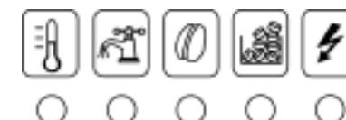
**Si tous les témoins clignotent en même temps:** cela signale un bloc mécanique dans la machine. Procéder au NETTOYAGE DE GROUPE D'INFUSION (cap. 8.1) et au DÉTARTRAGE DE LA MACHINE (chap. 9).
