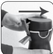
Pour fermer la machine à café à dosettes, vous poussez le couvercle vers le bas. Fermez maintenant la machine en poussant le bouton de couvercle vers le bas. Rassurez-vous que le bas du bouton de couvercle soit bien fermé. Après vous poussez le bouton de couvercle dans la direction de la machine pour la fermeture complète. Rassurez-vous que le bouton de couvercle est bien fermé avant d'utiliser la machine. Si non, de la vapeur peut échapper par le couvercle.
