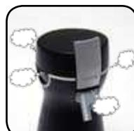
courant. L'appareil se refroidit et la pression de la vapeur disparaît. Si la pression est partie, vous pouvez à niveau ouvrir l'appareil et faire le nettoyage du préparateur de crème comme expliqués à la page 18.
