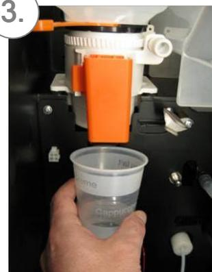
3. Um eine Probedosierung mit nur Kaffeemehl zu entnehmen, halten Sie nun einen Becher unter das Fallrohr und Drücken Sie die Programmtaste. Es wird nun eine Portion Bohnenkaffee ausgegeben.
