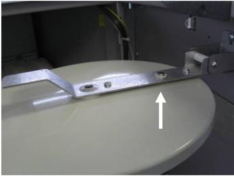
Becherturmdeckel mit Magnethalterung. Hält beim Öffnen am Türrahmen.
