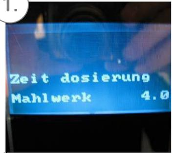
1. Öffnen Sie das Gerät und verriegeln Sie den Türkontakt damit das Gerät in Betrieb ist. Drücken Sie nun die Programmtaste und wählen Sie im Menü 1=Programmierung. Wählen Sie sich vor bis zur Programmierung Taste Bohnenkaffee schwarz. Nun gehen Sie zum Einstellpunkt: Zeit Dosierung Mahlwerk. Optimaler Wert des Parameters ist 4,0 Sekunden.
