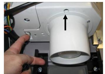
Nahezu fast Werkzeugloses Wechseln des Bechergebereinsatzes, eine Schraube ist zu lösen.
