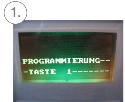
1. Wählen Sie die Programmierung Taste an, die Sie überprüfen, bzw. dosieren möchten. Drücken Sie dann die Taste 2 so oft bis die Laufzeit des gewünschten Produktes erscheint, z.Bsp. Laufzeit Produkt 1. Der Wert hier wird z.Bsp. mit 2.0 angezeigt. Dieser Wert entspricht der Laufzeit in Sekunden, und kann mit der Taste 4 und 5 auf der Anwahlstatatur verändert werden.
