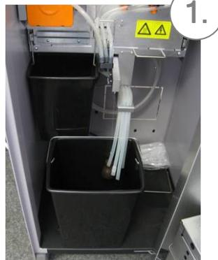
Öffnen Sie Gerät. Schliessen Sie die Wasserzufuhr und entnehmen Sie den Kaffeesatzzeimer
