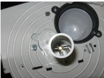
Becherturmantrieb, der Becherturm muss hier richtig eingeführt werden.
