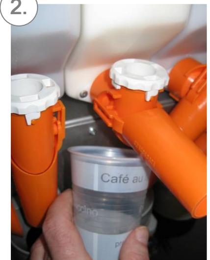
2. Klappen Sie die Produktrutschen nach oben, um eine Probedosierung mit nur dem Produkt zu entnehmen und halten Sie nun einen Becher unter das Fallrohr und Drücken dann die Programmtaste. Auf der Innentastatur. Es wird nun eine Portion von diesem Produkt ausgegeben.
