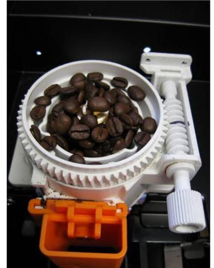
Das Mahlwerk ist zeitgesteuert und ohne Dosierer. Mahlen Sie Nie zu fein, dass kann dem Brüher und der Pumpe schaden. **Lesen Sie hierzu das Kapitel Einstellung der Direktmahlung.**
