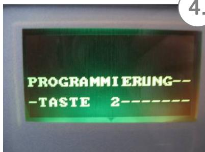
4. Falls nötig, verändern Sie die Laufzeit mit der Taste 4 erhöhen, mit der Taste 5 weniger. Ermitteln Sie so die richtige Dosiermenge für die Produkte die das Getränk benötigt. Drücken Sie dann weiter für die Programmierung der Taste 2....Taste 3...usw. Passen Sie dann auch die Wassermengen an, am besten mit dem Freiverkauf eines Produktes.
