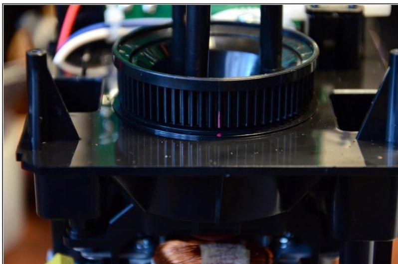
Далее отвинчиваем (можно не до конца) винты крышечки шестерни.
