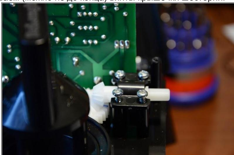
Когда шестерня свободно вращается - поворачиваем большой диск по часовой стрелке (в моем случае на 4 щелчка).
