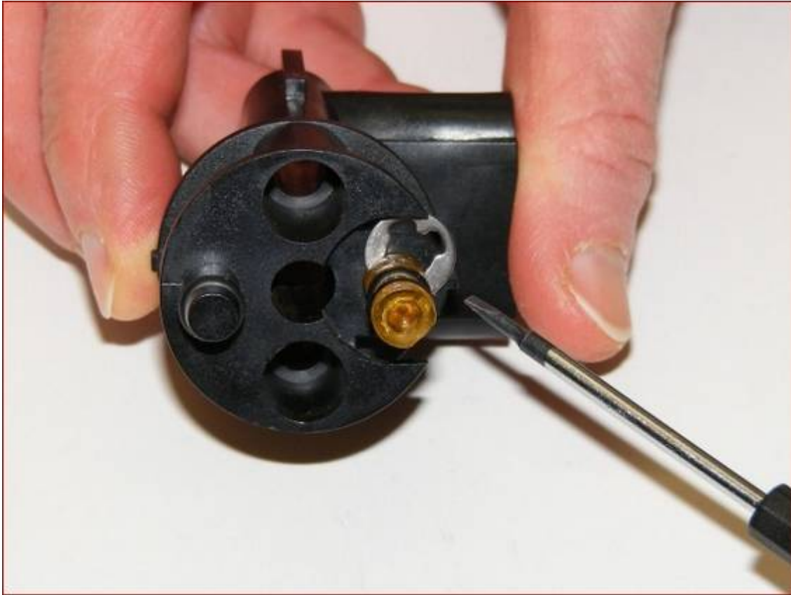
Federring des Anschlussbolzens abnehmen
